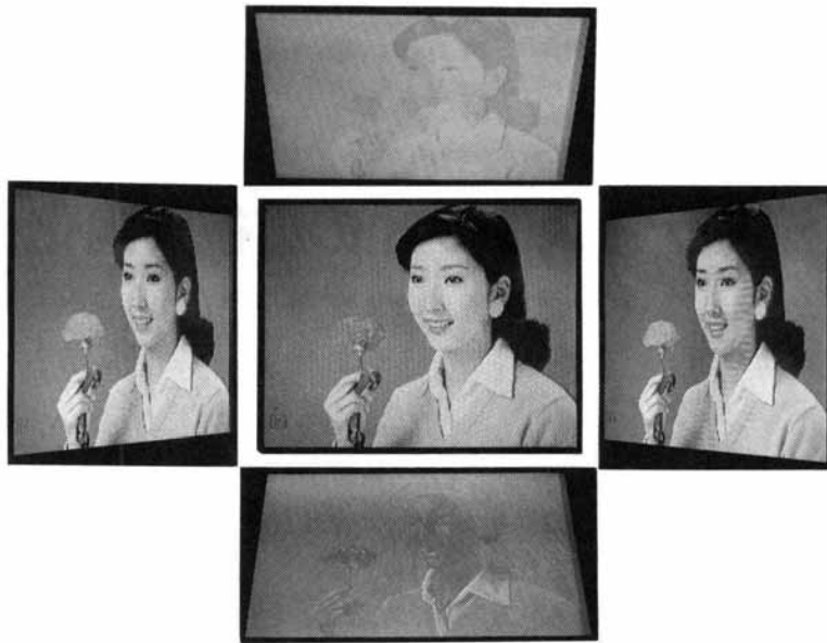
TFT-LCD パネルの視角特性
