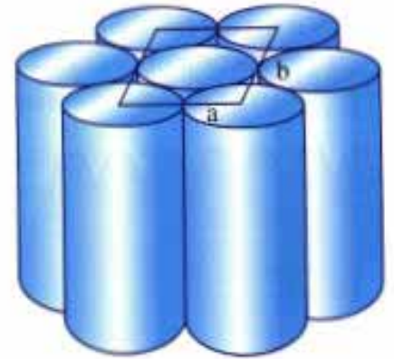
圖三(d) 層列E相的結構
