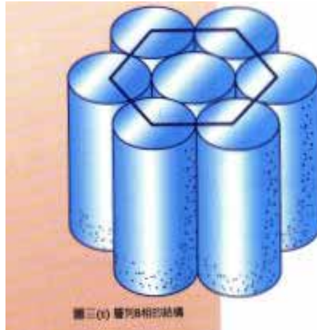
圖三(d) 層列E相的結構
