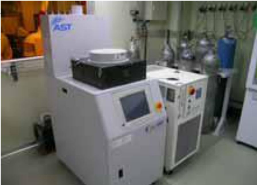
反應性離子蝕刻(RIE)系統, NTNU MOEMS Lab.
